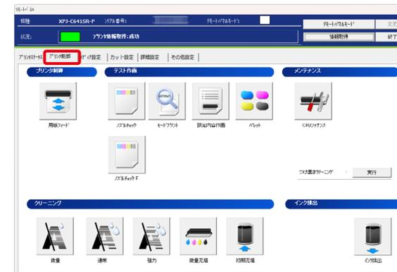
3 [クリーニング] からクリーニングモード (微量 / 通常 / 強力) を選択して、クリックします。
